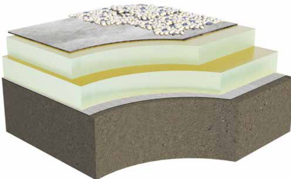
Unbelüftetes Dach (Warmdach): Umkehrdach
