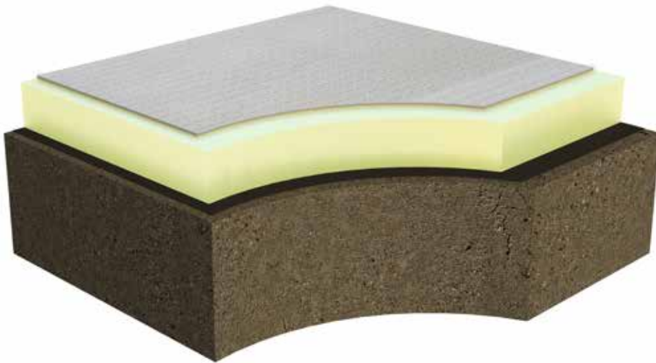
Unbelüftetes Dach (Warmdach): Normaldach
